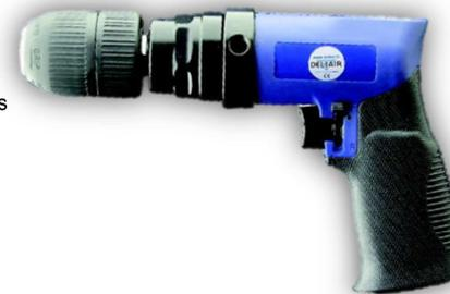
Machine de perçage. Corps en composite. Poignée ergonomique avec revêtement isolant. S'utilise avec des forets de diamètre de 10 mm maximum. Equipée d'un mandrin auto-serrant. La réversibilité du moteur permet d'envisager les travaux de vissage et dévissage, perçage spéciaux à gauche, perçage avec scie cloche.
