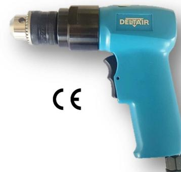
*Machine de perçage industrie. Corps en Acier. Fournie avec poignée latérale pour droitier ou gaucher. S'utilise avec des forets de diamètre de 10 mm maximum. Equipée d'un mandrin à clé acier. La réversibilité très pratique par double gâchette permet d'envisager les travaux de taraudage et également de vissage/dévisage, perçage spéciaux à gauche, perçage avec scie cloche.*
